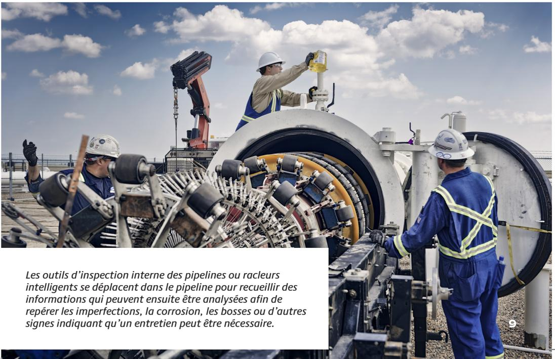
*Les outils d'inspection interne des pipelines ou racleurs intelligents se déplacent dans le pipeline pour recueillir des informations qui peuvent ensuite être analysées afin de repérer les imperfections, la corrosion, les bosses ou d'autres signes indiquant qu'un entretien peut être nécessaire.*
