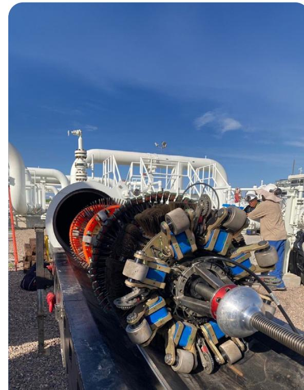
En 2024, nous avons investi dans le développement, l'expérimentation et la mise en œuvre de technologies améliorées d'inspection interne de canalisation. L'amélioration de la précision et de la fiabilité des résultats des inspections internes nous permet de déployer nos ressources d'entretien plus efficacement là où elles sont le plus nécessaires et au moment le plus approprié.
